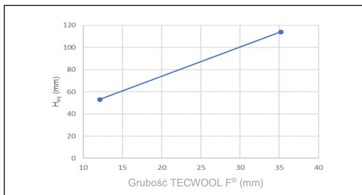
Rys. A.2.8: Równoważna grubość betonu (90 minut)
